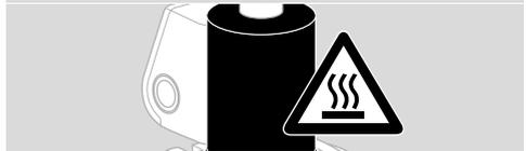
→ Utilizzare un cavo termoresistente (> 80 °C).
