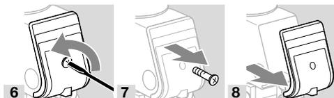
→ Smontare il collegamento a vite M20 o altri tipi di collegamento.
