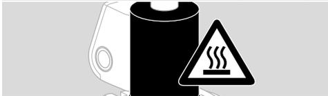
→ Temperaturbeständiges Kabel (> 80 °C) verwenden.
