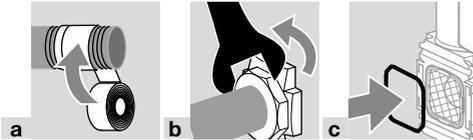
→ O-Ring und Sieb (Bild c) müssen eingebaut sein.
