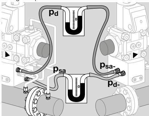
**3** Abrir a válvula de ajuste de precisão VMV lentamente, da mistura inflamável com excesso de ar até ao valor desejado.
