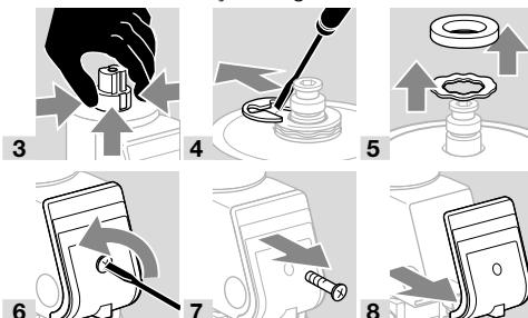
→ Desmontar o prensa cabo M20 ou outro tipo de conexão elétrica.
