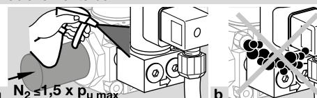
Verificar a estanqueidade da válvula de bypass/gás piloto no lado da entrada e da saída.
