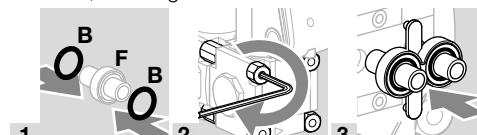
**4** No lado de montagem da válvula de bypass, retirar os tampões.
