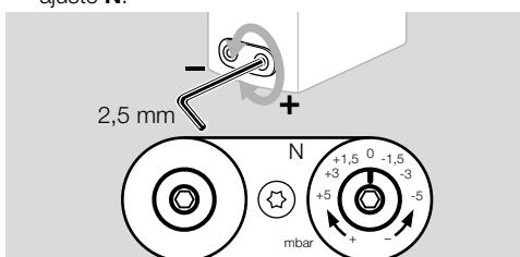
→ Ajuste pela fábrica: Posição zero N = -1,5 mbar
