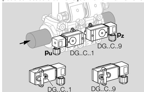
→ Se o pressostato de gás for reequipado, ver as instruções de operação incluídas: "Pressostato de gás DG..C", capítulo "Montar o DG..C.. na válvula solenoide para gás valVario".
