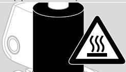
→ Utilizar cabos resistentes à temperatura (> 80°C).
