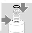
→ Quando o aparelho existente possui um anel O'ring em este ponto (seta), trocar o açãoamento como descrito aqui: VAX/VCX 1: utilizar todas as vedações contidas no kit adaptador de açãoamento. VAX/VCX 2-VAX/VCX 3: utilizar a vedação pequena e somente uma vedação grande do kit adaptador de açãoamento.
