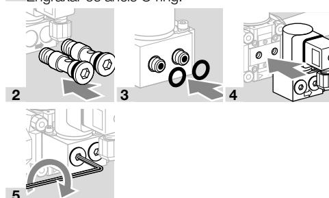
→ Apertar os parafusos de fixação alternando para que a VBY esteja bem presa na VAx.
