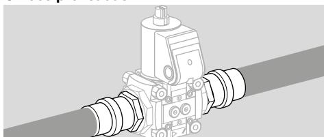
→ As vedações de algumas uniões prensadas estão aprovadas até 70°C (158°F). Este limite de temperatura é observado com uma vazão através da tubulação de no mínimo 1 m³/h (35,31 SCFH) e uma temperatura ambiente de no máximo 50°C (122°F).
