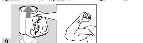
→ В зависимости от конструктивного исполнения прибора привод заменяется двумя различными способами: Если у прибора на обозначенном стрелкой месте нет О-кольца, замените привод описанным здесь способом. В противном случае следуйте последующим указаниям.
