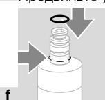
→ Если у прибора на обозначенном стрелкой месте имеется О-кольцо, замените привод описаным здесь способом: VAN 1: используйте все уплотнения из адаптерного комплекта для привода. VAN 2: используйте маленькое и только одно большое уплотнение из адаптерного комплекта для привода.
