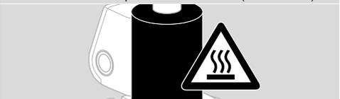
→ Temperaturbeständiges Kabel (> 80 °C) verwenden.
