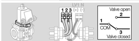
→ En cas de montage de deux embases sur VAN avec indicateur de position : marquer les embases et les connecteurs afin d'éviter toute interversion.
