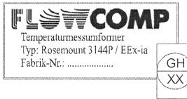
Amtliche Klebmarke(n) sichern das Typenschild (an geeigneter Stelle des Gehäuses angebracht) und die Elektronikseite.
