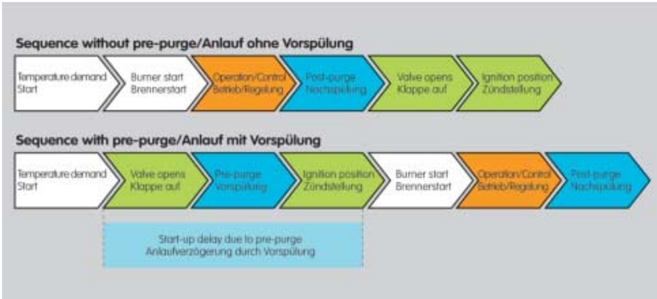
»4 Quick start of the burner system after a controlled shut-down »4 Schneller Anlauf des Brennersystems nach Regelabschaltung
