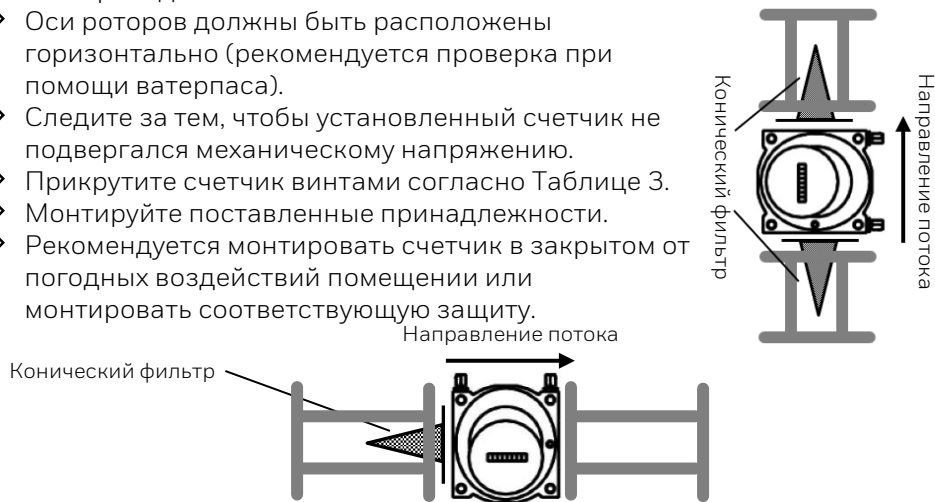
Рис. 11 | Установка конического фильтра
