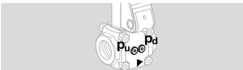
→ Tetningene for noen gasspressfittings er godkjent for inntil 70 °C (158 °F). Denne temperaturgrensen overholdes ved en gjennomstromming på minst 1 m³/h (35,31 SCFH) gjennom ledningen og en omgivelsestemperatur på maks. 50 °C (122 °F).
