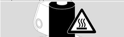
→ Utilizar cabos resistentes à temperatura (> 80°C).
