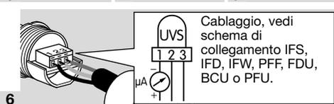
→ Sui morsetti a molla si possono collegare anche conduttori flessibili senza capicorda. Per inserire un conduttore flessibile occorre aprire il morsetto con il pulsante di azionamento.
