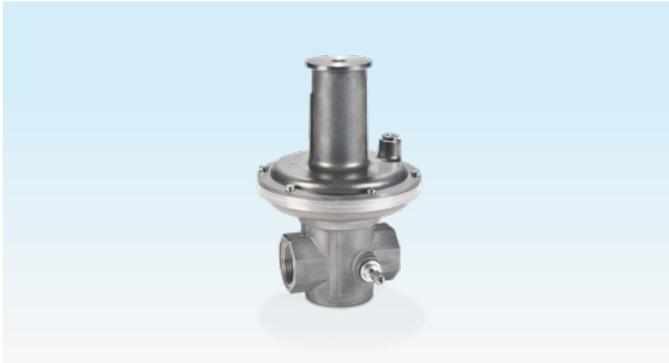
Ablaseventil zum Abbau kurzzeitig auftretender Druckstöße in Regelstrecken, um ein ungewolltes Ansprechen des Sicherheitsabsperrventiles JSAV zu verhindern. Ein zu hoher Druckanstieg bei auftretenden Leckgasmengen infolge nicht dicht schließender Gasdruckregelgeräte wird vom VSBV abgebaut.
