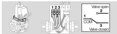
→ En caso de montaje de dos conectores en VAA con indicador de posición: marcar las bases de conector y los conectores para evitar que se intercambien.
