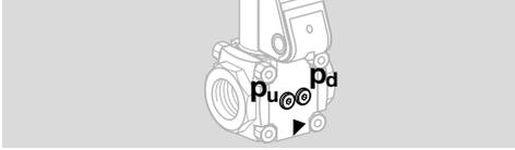
→ Las juntas de algunos accesorios de conexión a presión para gas están homologadas hasta 70 °C (158 °F). Este límite de temperatura se mantiene con un caudal mínimo de 1 m<sup>3</sup>/h (35,31 SCFH) a través de la tubería y una temperatura ambiente máxima de 50 °C (122 °F).
