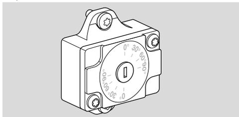
Se puede montar el bypass al lado izquierdo y/o al lado derecho del cuerpo de flujo.
