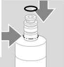
→ Si l'appareil dispose d'un joint torique à cet endroit (flèche), changer la commande en se référant aux consignes ci-après : VAA 1 : utiliser tous les joints du kit d'adaptation de la commande. VAA 2, VAA 3 : n'utiliser que le petit joint ainsi qu'un des joints de grande taille du kit d'adaptation de la commande.
