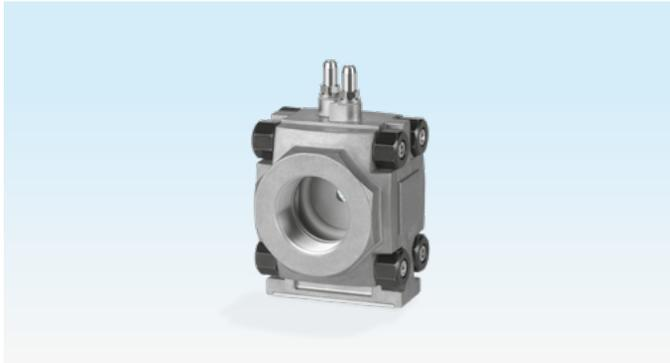
Le diaphragme de mesure VMO valVario est monté dans les lignes de gaz et de sécurité ainsi que dans les lignes d'air de la production industrielle et collective de chaleur. En combinaison avec des électrovannes gaz et des vannes de réglage gaz valVario, elle peut être utilisée comme obturateur.
