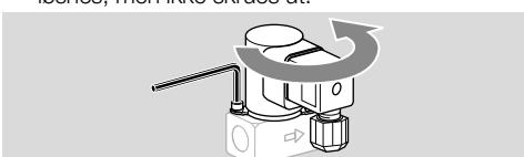
→ Stram skruene godt til igjen når magnetaktuatoren er i ønsket posisjon.
