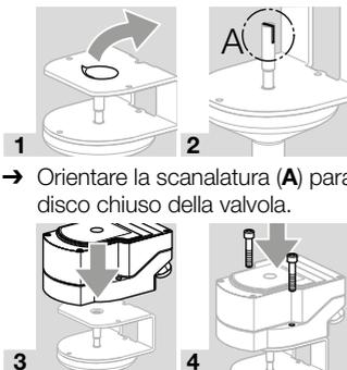
1 Orientare la scanalatura (A) parallelamente al disco chiuso della valvola.
