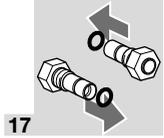
→ Ao montar, colocar novos anéis O-ring do kit de vedações.
