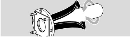
**3** Con una cinta adhesiva convencional, envolver firmemente la capa de fibra, comenzando desde arriba alrededor del tubo radiante por toda la longitud hasta el anillo de apriete, comprimiéndola del 25 % aproximadamente.
