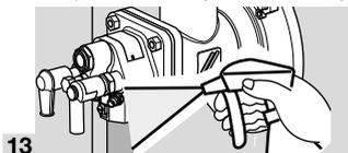
15 Выведите горелку на минимальную нагрузку и сравните значения настроенных давлений с записанными в протоколе приемки-сдачи.
