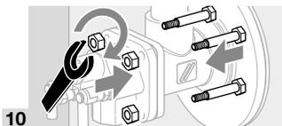
→ Затяните крест-накрест винты газового узла: BIC(A) 50 – 100 с макс. моментом 15 Н·м (11 lb ft), BIC 125 – 140 с макс. моментом 30 Н·м (22 lb ft).
