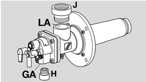
→ **BIC 125, BIC 140, BICW:** приварите фланец **K** к трубе воздухопровода **P** для воздушного подключения **LA** и используйте резьбовой адаптер NPT **H** для газового подключения **GA**.
