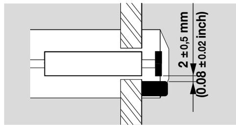
**8** Cuando se ha enfriado la cámara del horno, comprobar el tubo del quemador y el bloque refractario a través de la brida del horno.
