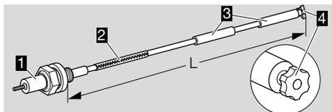
**4** Si están dañados el pomo en estrella **4** o el aislante **3**, sustituir el electrodo.
