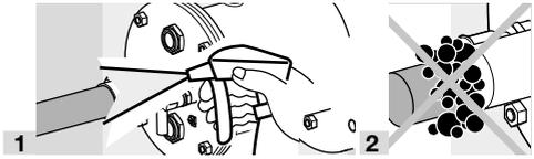
→ Evitar la formación de agua de condensación por penetración de atmósfera del horno en el cuerpo del quemador. En caso de temperaturas de horno superiores a 500 °C (932 °F) enfriar constantemente el quemador desconectado con un pequeño caudal de aire – ver página 9 (6.6 Aire de enfriamiento).
