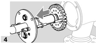
→ Tan pronto como se ha desmontado el cuerpo de gas del quemador, se debe cambiar la junta de la brida de conexión.
