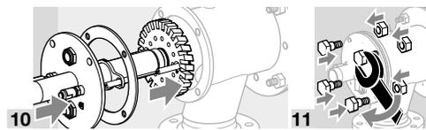
→ Atornillar el cuerpo de gas del quemador con máx. 37 Nm (27,3 lb ft).
