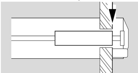
→ Distancia del electrodo de encendido a la clavija de masa o a la tobera de gas:  $2 \pm 0,5$  mm ( $0,08 \pm 0,02$ ").
