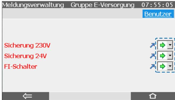
Abb. 2-2: Detailanzeige für die Einzelmeldungen in einer Alarm-Gruppenmeldung nach Benutzerlogin – Beispiel
