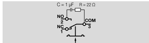
→ Cuando el presostato se conecta a una tensión > 24 V (> 30 V) y una corriente > 0,1 A con  $\cos \varphi = 1$  o > 0,05 A con  $\cos \varphi = 0,6$ , se quema la capa dorada en los contactos. Después solo podrá funcionar con esta tensión o una superior.
