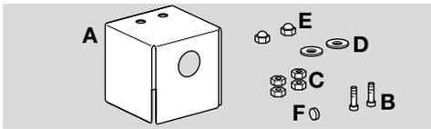
En caso de instalación al aire libre, la tapa protectora contra la intemperie ofrece una protección duradera que evita la formación de condensación y la descomposición de las partes del cuerpo.
