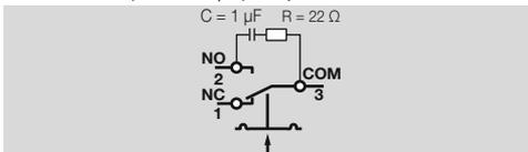
→ Wenn der Druckwächter einmal eine Spannung  $> 24 \text{ V}$  ( $> 30 \text{ V}$ ) und einen Strom  $> 0,1 \text{ A}$  bei  $\cos \varphi = 1$  oder  $> 0,05 \text{ A}$  bei  $\cos \varphi = 0,6$  geschaltet hat, ist die Goldschicht an den Kontakten weggebrannt. Danach kann er nur noch mit dieser oder höherer Leistung betrieben werden.
