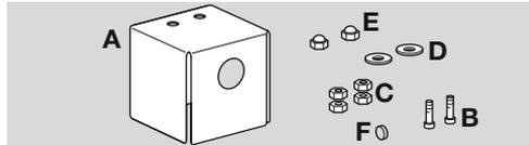
Bei Einbau im Freien ist die Wetterschutzhaube ein dauerhafter Schutz, um die Bildung von Kondenswasser und Verwitterung der Gehäuseteile zu vermeiden. Die Wetterschutzhaube besteht aus 1 mm Edelstahl. Die beigelegte Filtermatte soll den offenen 1/8"-Anschluss gegen eindringenden Schmutz und Insekten schützen.
