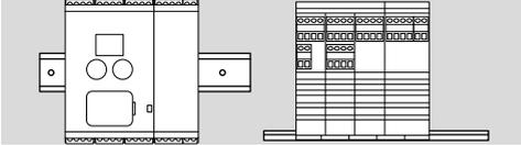
→ Une position à la verticale nécessiterait l'ajout des butées d'arrêt (par ex. Clipfix 35 de la société Phoenix Contact) pour éviter le glissement du BCU.
