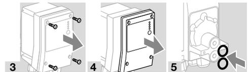
→ Os anéis O'ring devem estar inseridos nos bicos de conexão do TC.
