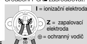
**5** Ionizační a zapalovací vedení utáhněte s 5 Nm (šroub s drážkou), přitom elektrodu zajistěte sevřením šestihranu proti otvoření.
