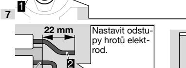
Přesunout zadní vodiční drážku směrem k tělesu hořáku až na doraz. Utáhněte šroub s dotažovacím momentem max. 1,5Nm. Utáhněte šroub s dotažovacím momentem max. 1,5 Nm.
