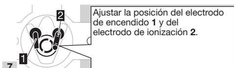
Ajustar la posición del electrodo de encendido 1 y del electrodo de ionización 2.
