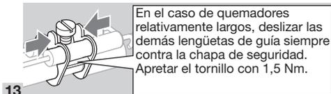
En el caso de quemadores relativamente largos, deslizar las demás lengüetas de guía siempre contra la chapa de seguridad. Apretar el tornillo con 1,5 Nm.
