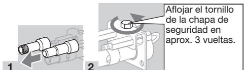
Aflojar el tornillo de la chapa de seguridad en aprox. 3 vueltas.
