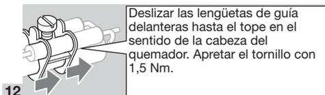
Deslizar las lengüetas de guía delanteras hasta el tope en el sentido de la cabeza del quemador. Apretar el tornillo con 1,5 Nm.
