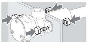
4 Conectar la tubería del gas de encendido con Rp ¼ y la tubería del aire con Rp ½.
