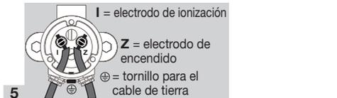
6 Apretar los cables de ionización y de encendido con 5 Nm (tornillo de cabeza ranurada), para ello contraatornillar el electrodo del hexágono para evitar que se desatornille.
