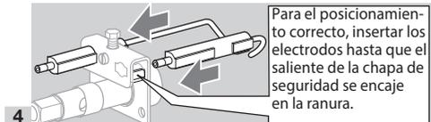
Para el posicionamiento correcto, insertar los electrodos hasta que el saliente de la chapa de seguridad se encaje en la ranura.
