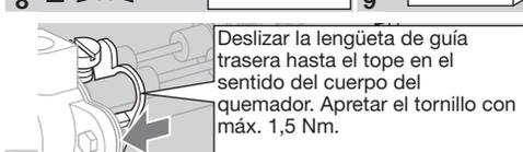
Deslizar la lengüeta de guía trasera hasta el tope en el sentido del cuerpo del quemador. Apretar el tornillo con máx. 1,5 Nm.
