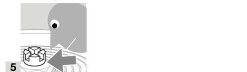
→ Электромагнитный привод с муфтой сцепления слегка сместите (около  $10^\circ$ ) при установке относительно соединительного захвата дискового затвора.
