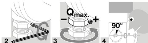
→ Pour régler  $Q_{min.}$ , la commande magnétique doit être hors tension.
