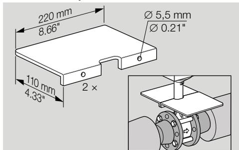
La commande magnétique peut être utilisée en combinaison avec la vanne papillon BVHM pour air chaud :
