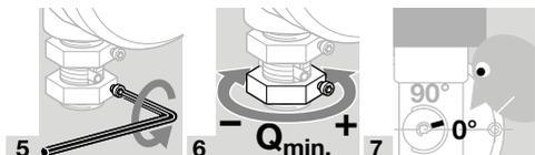
8 Une fois le réglage réussi, serrer les deux vis des écrous de réglage de  $Q_{min.}$  et  $Q_{max.}$ .
