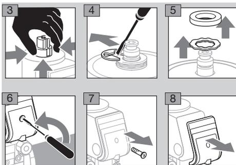
▷ Smontare il collegamento a vite M20 o altri tipi di collegamento.
