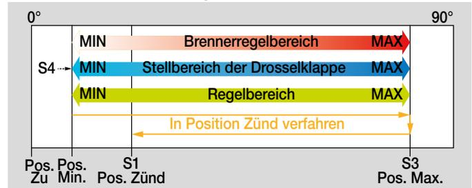
Über den Ausgang Regelfreigabe (Klemme 56) wird im Betrieb die Regelung freigegeben. Während der Regelfreigabe lässt sich der Stellantrieb über seinen Analogeingang (Klemmen 17 und 18) stufenlos zwischen den Positionen für maximale und minimale Leistung steuern. Hierbei ist kein Timeout aktiv.
