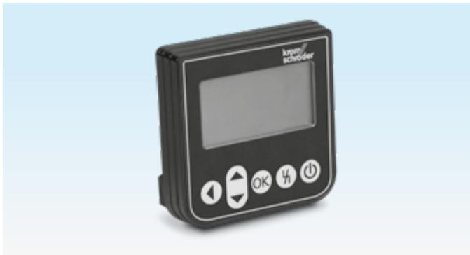
Die OCU ist eine externe Bedieneinheit, die an ein Steuergerät der FCU 500-/BCU 500-Serie angeschlossen werden kann. Die externe Bedieneinheit OCU wird in die Tür eines Schaltschranks eingebaut. Dadurch muss der Schaltschrank nicht geöffnet werden, um Prozesswerte, Statistiken, Flammensignalstärken oder Parameterwerte auszulesen, Einstellungen an der OCU zu ändern oder angeschlossene Klappen im Handbetrieb anzusteuern und zu justieren.
