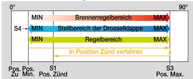
Über den Ausgang Regelfreigabe (Klemme 56) wird die Regelung für den Betrieb freigegeben. Während der Regelfreigabe lässt sich der Stellantrieb durch einen externen 3-Punkt-Schritt-Regler stufenlos zwischen den Positionen für maximale und minimale Leistung steuern. Hierbei ist kein Timeout aktiv.
