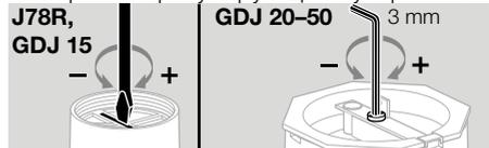
→ По часовой стрелке: повышение давления на выходе, против часовой стрелки: понижение давления на выходе.
