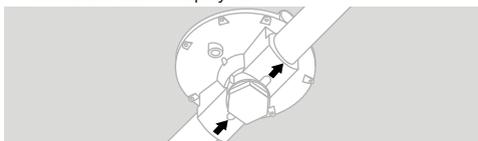
3 Монтируйте прибор с помощью допущенного уплотнительного материала.
