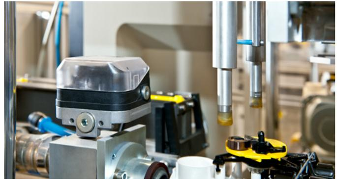
Le contrôle de la dépression permet de s'assurer que les composants sont correctement placés lors du montage entièrement automatisé des compteurs de gaz.
