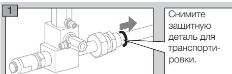
Снимите защитную деталь для транспортировки.
