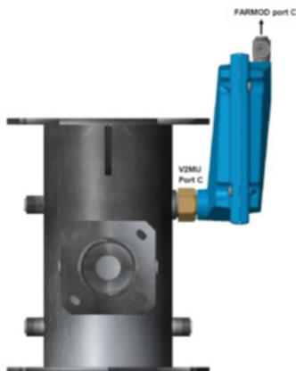
**Fig. 4. Exemplo de montagem do permutador de calor com a orientação vertical da unidade de mistura (mostrada com uma unidade de mistura de 300 kW).**
