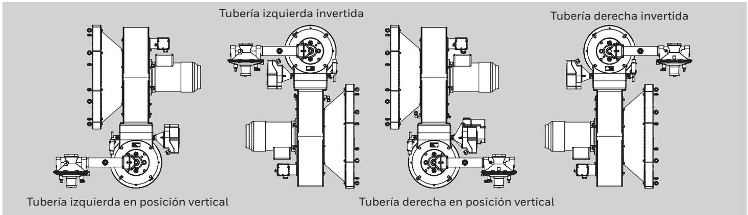
A pesar de que el motor del soplador está en el lado “izquierdo” de las unidades invertidas, sigue siendo un motor “derecho” en relación con el conjunto del soplador.
