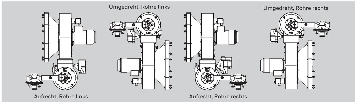
Obwohl sich der Gebläsemotor auf der „linken“ Seite der umgedrehten Einheiten befindet, handelt es sich in Bezug auf die Gebläsebaugruppe weiterhin um einen „rechten“ Motor.
