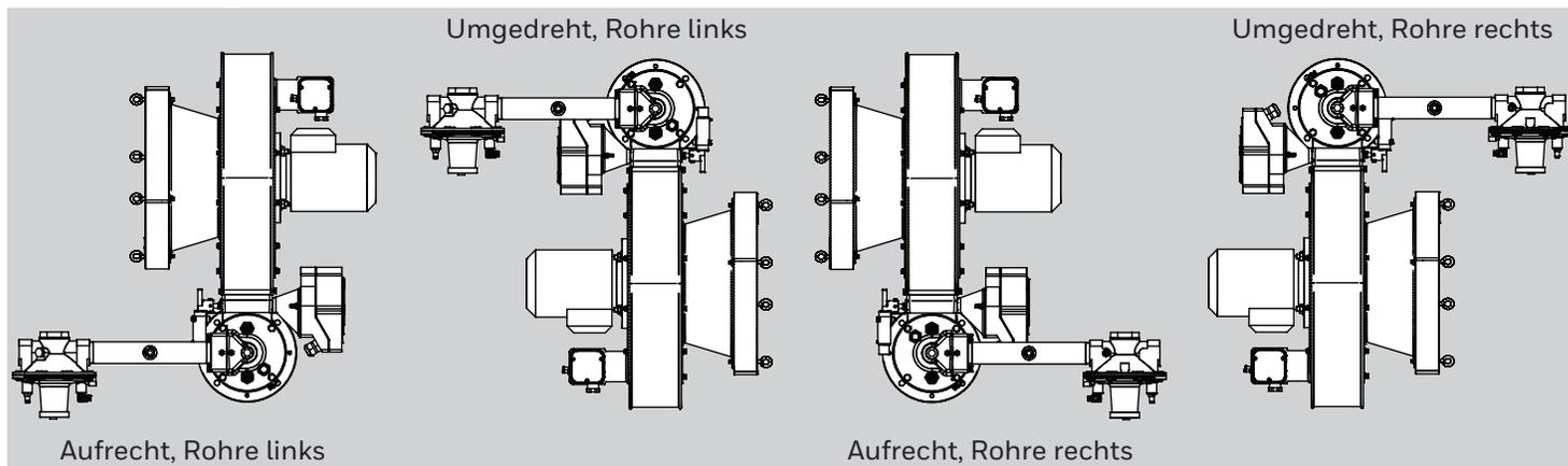
Obwohl sich der Gebläsemotor auf der „linken“ Seite der umgedrehten Einheiten befindet, handelt es sich in Bezug auf die Gebläsebaugruppe weiterhin um einen „rechten“ Motor.
