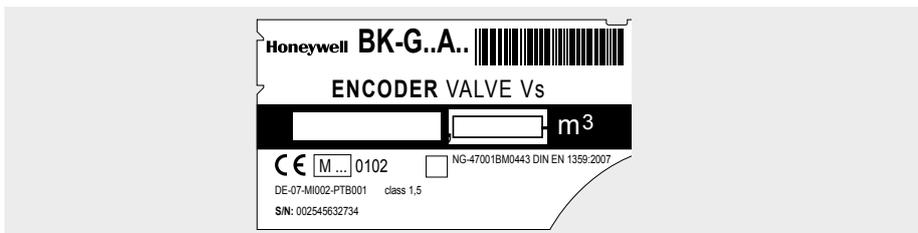
Auf dem Zifferblatt des Absolut-ENCODER AE2/AE3 sind die individuellen techni-schen Daten und der Typ des Übertragungsprotokolls ablesbar.
