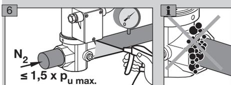
▷ Conduite non étanche : contrôler le joint d'étanchéité.
