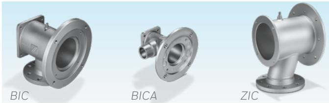
Der Brenner wird über das Brennergehäuse am Ofen befestigt. Das Brennergehäuse nimmt den Brenneinsatz und das Keramikrohr auf und führt die Verbrennungsluft. Über einen Luftmess-Stutzen kann der Verbrennungsluftdruck abgenommen werden.
