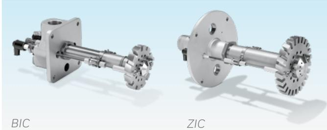
Das Brenngas wird über den Gasanschluss und den Gasstutzen zum Brennerkopf geführt. Die Brenner sind mündungsmischende Brenner. Erst im Brennerkopf werden Gas und Luft gemischt. Dadurch wird verhindert, dass explosive Gase in den Rohrleitungen entstehen.
