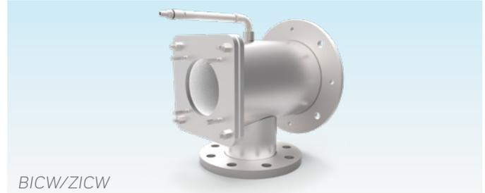
Brennergehäuse mit Isolierung können für höhere Warmlufttemperaturen bis 600 °C (1112 °F) eingesetzt werden. Die Isolierung besteht aus vakuumgeformten Keramikfasern (RCF = refractory ceramic fibre) mit einer speziell gehärteten Oberfläche. Sie dient dazu, die Gehäuseoberflächentemperatur zu reduzieren und die verwendeten Materialien gegen Überhitzung zu schützen. Damit der Luftmess-Stutzen kühl bleibt, ist dieser nicht direkt, sondern mit Abstand zum Gehäuse montiert.
