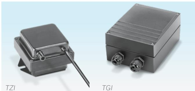
Für die Brenner empfehlen wir die Zündtransformatoren TZI oder TGI mit einer Spannung  $> 7,5$  kV und einem Ausgangsstrom  $> 12$  mA.
