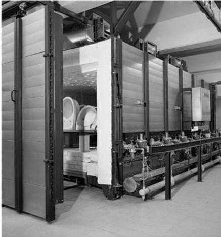
*Keramikofen mit Temperaturregelung über Taktsteuerung*
