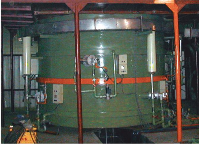
Chauffage direct d'une cloche à recuire. Les fumées sont recyclées par l'intermédiaire de l'éducteur.
