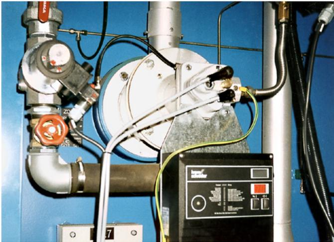
Chauffage direct d'un four à sole roulante.
