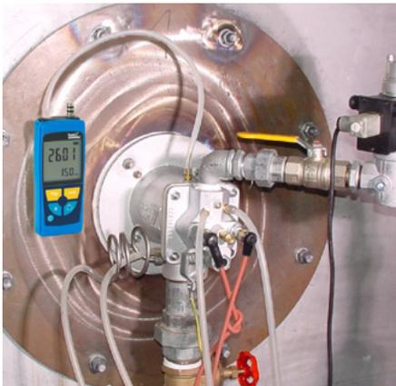
Ein Magnet an der Geräterückseite erlaubt freihändiges Arbeiten, z. B. während Einstellungsarbeiten am Brenner.
