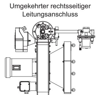
Selbst wenn sich der Gebläsemotor auf der „linken“ Seite der umgedrehten Einheiten befindet, ist er hinsichtlich des Gebläseaufbaus immer noch ein „rechtsseitiger“ Motor.
