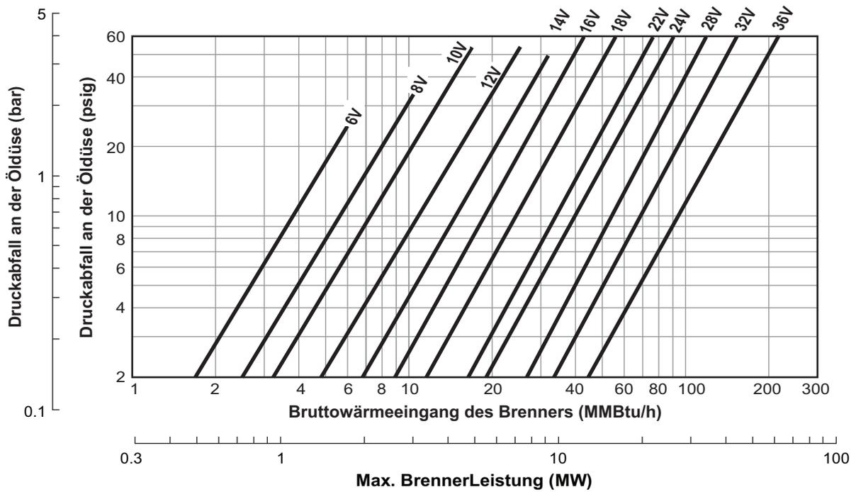
**Anmerkung:** Die Kurven des Brennstoffdruckabfalls sollten als Orientierung für die Einstellung des Brenners verwendet werden. Es wird empfohlen, zur Bestimmung des tatsächlichen Brennstoffdurchflusses den Brennstoffdurchfluss direkt zu messen (Drosselblende oder Durchflussmesser)..
