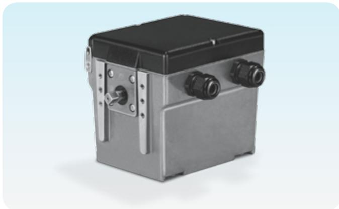
Le servomoteur GT 50 est monté directement sur une vanne papillon comme DKR par ex., pour permettre de régler le débit de gaz et d'air des brûleurs gaz. Le servomoteur GT 50 est conçu pour toutes les applications exigeant une rotation exacte comprise entre 0° et 90° ou 0° et 160°.
