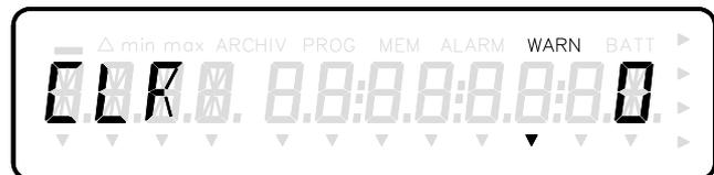
**Anmerkung:** bei dem o.a. Fehler muss unbedingt auch das Datum und die Uhrzeit überprüft und eingestellt werden, da nach dem Anstecken der Batterie eine altes Datum und Uhrzeit aus dem EEPROM gelesen wird !
