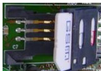
SIM-Karte in aufgeklappten Teil des Halters schieben. Dabei darauf achten, dass die abgeflachte Ecke der SIM-Karte unten links ist und die Kontakte nach unten zeigen.
